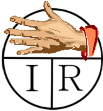
たとえば電圧(V)を求める場合、Vを隠すとIRが横並びで残ります。これを $I \times R$ と考えます。
