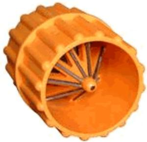
VE 管のバリ取りに使用します。凸部で内バリを削り、凹部で外バリを削ります。
