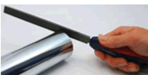
薄鋼管・厚鋼管のパイプの面取りに使用
